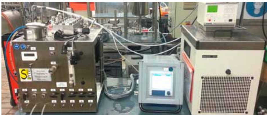
Abb. 3: CUBE80-Testanlage (links) im Labor mit Messbox (Mitte) zur Datenerfassung und -visualisierung und Thermostat (rechts) [Foto: Lehrstuhl für Lebensmittel- und Bioprozesstechnik der TU München (Wissenschaftszentrum Weihenstephan)]
