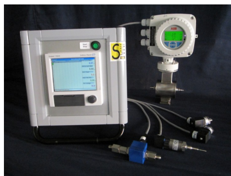
Abbildung 1: Durch die leicht zu installierende SIMA-tec® Messbox ist Datenerfassung kein Problem mehr
