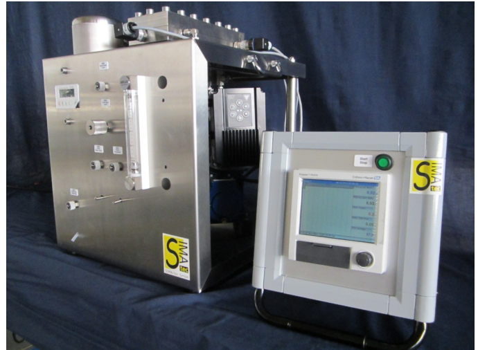
Abbildung 2: Der CUBE 80-VA deckt den Bereich der Nanofiltration und Umkehrosmose ab - bis zu 80 bar!!
