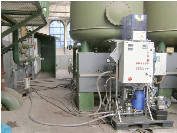
Bild 1: Betrieblicher Einsatz des mobilen BFI-Magnetabscheiders im Bypass zum Kiesfilter
