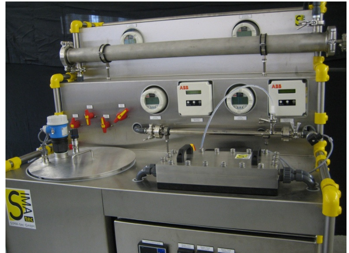
Abbildung 2: „Allrounder“ - Testanlage für direkte Vergleiche zwischen Flachmembranen und Rohrgeometrien im Bereich Mikro-/ Ultrafiltration und Pilotversuche bis 16 bar
