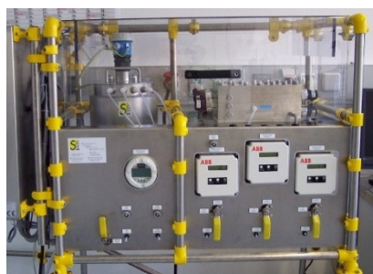
Abbildung 1: Testanlage LSta80 für Laboruntersuchungen im Bereich Nanofiltration/Umkehrosrose
