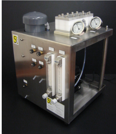
Abbildung 1: MF-CUBE bestückt mit der SIMA-tec Testzelle UF10K
