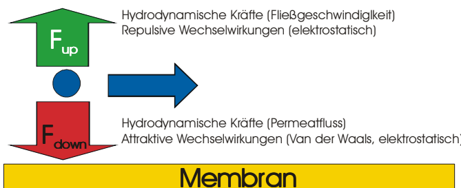
Abbildung 1: Auf Feedbestandteile wirkende Kräfte während der Filtration
