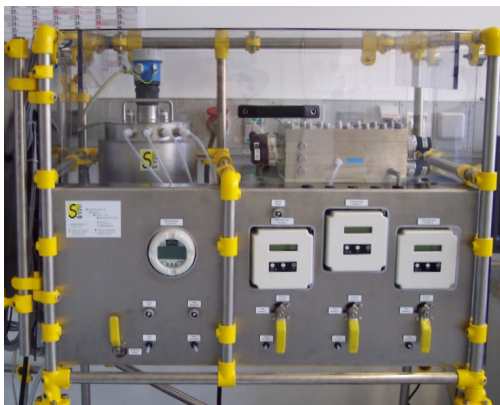
Abbildung 1: LSta80 mit neuen magnetisch-induktiven Volumenstromsensoren
