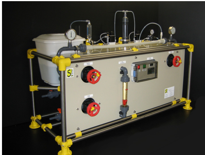
Abbildung I: Testanlage für Rohr- und Kapillarmembranen mit SPS-gesteuerter Rückspüleinrichtung
