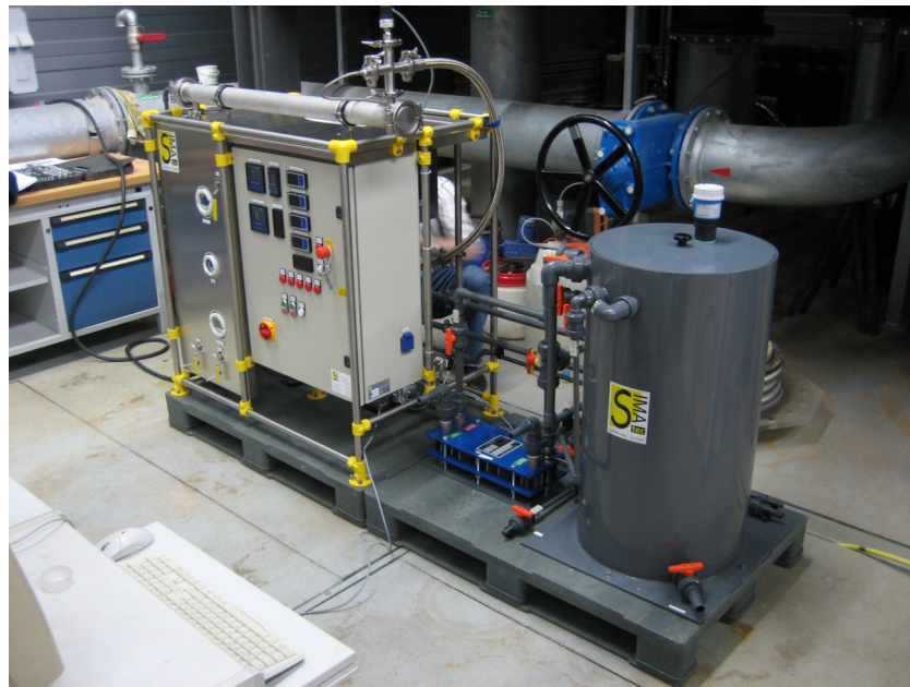
Bild 1: PSta40 - Beispielanlage mit 2,5“-Modul
